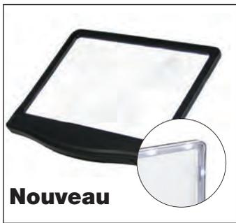
Une grande surface pour l'observation d'objets ou pour la lecture. Grossissement à 300% (3x). Plaque de grossissement non réfléchissante. Pour un éclairage optimal, 12 LED sont disposées autour de la lentille. Fonctionne avec 3 micro-piles 1.5V AAA non fournies. La loupe couvre uniformément toute la surface. Idéal pour la lecture.
