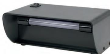
Lampe ondes courtes fonctionnant sur secteur. Équipée d'un tube UV 254 nm, 4 Watt. Son capot permet de travailler à l'abri de la lumière. Un bon rapport qualité-prix. Dimensions : 180 x 120 x 60 mm.
