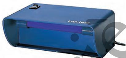
Lampe UV fonctionnant sur secteur. Équipée d'un tube UV 366 nm, 4 Watt. Son capot permet de contrôler billets et timbres à l'abri de la lumière. Un bon rapport qualité-prix. Dimensions : 180 x 120 x 60 mm.
